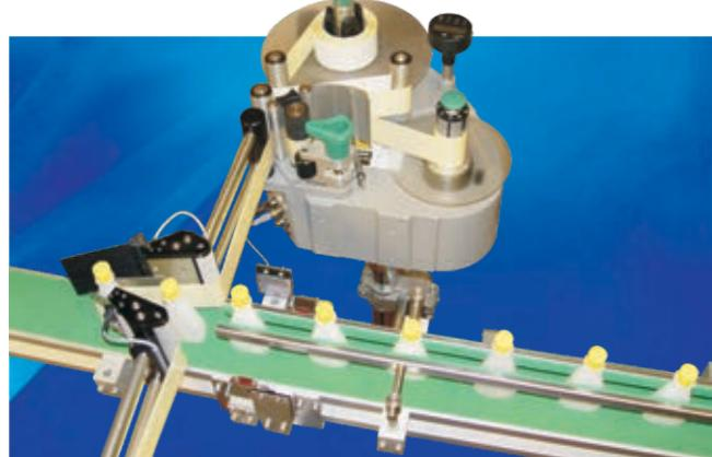
Аппликаторы способны выполнять боковое, нижнее, верхнее наклеивание этикеток, а также нанесение этикеток под разными углами на конусовидные продукты. Автоматические аппликаторы ALS можно установить в любые технологические линии, в том числе в этикетировщики «карусельного» типа.
