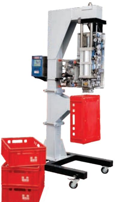
Модель H-PAD принтера Coditherm была разработана компанией «Eidos» специально для нанесения переменной буквенно-цифровой информации и штрихкодов на углубления (зоны пазов) пластиковых контейнеров. Принтер Coditherm H-PAD оснащен мощным пневмоцилиндром, способным развивать силу давления до 2000 кгс, а также новыми нагревателями для улучшения рабочих характеристик подушки печати.
